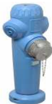
Poteaux d'aspiration de 100 mm à réseau sec, munis d'une seule sortie de 100 mm. Pas de volant ni de carré de manœuvre.
